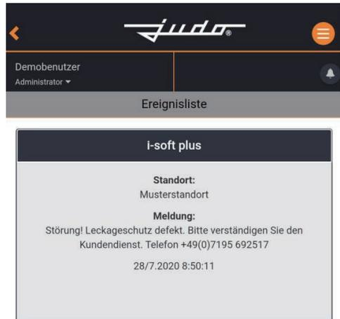
圖 8：透過「事件清單」按鈕可以查看設備的最近通知消息。
