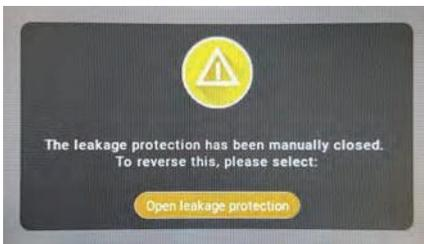
**i** 若要重新啟用防漏機制，請點擊 *Open leakage protection* 按鍵。
