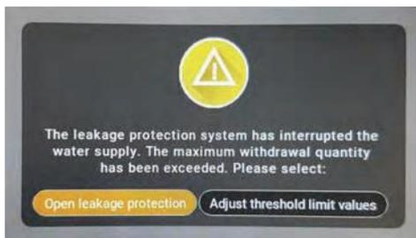
Fig. 15: 具有自動關閉漏水保護功能的顯示指示程序:
