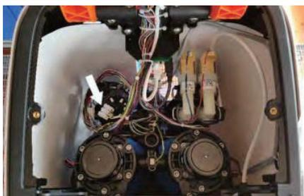
5. 將要連接的電纜穿過設備後面板的開口，並將其連接到光澤端子 (COM-NO- NC)。
