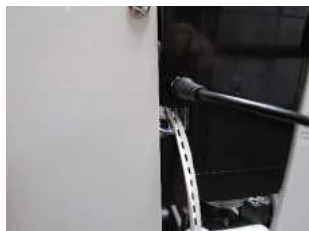
圖10： 取下灰色蓋子，將 LAN 纜線 穿過開口。
