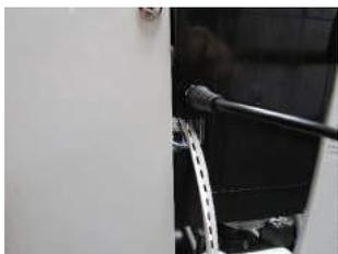
圖 11：取下灰色蓋子，將 LAN 纜線穿過開口
